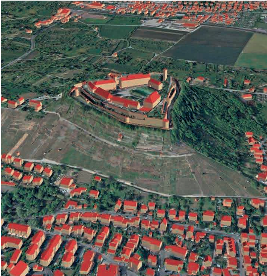
Eine Kombination aus 3D-Gebäudemodell, Digitalem Geländemodell und Digitalem Orthophoto. Auch für den Laien erkennbar: die erhabene Festung Hohenasperg.
