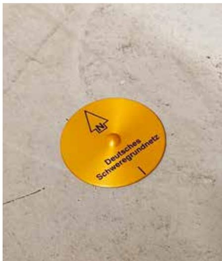
**Der Messpunkt des Deutschen Schweregrundnetzes ist jetzt dauerhaft markiert.**
