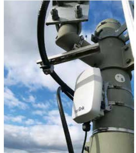
**LoRa-Gateway in Nahaufnahme: Kann viel und ist einfach zu montieren.**
