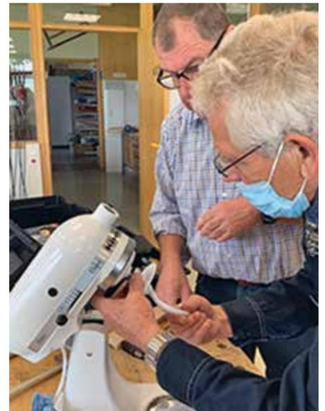
**Ihnen ist nichts zu schwer: Rainer Russ (Ingenieur für Elektronik) und Karl-Heinz Maas (Mechatroniker), beide im Ruhestand, reparieren eine defekte Küchenmaschine bei welcher der Antrieb blockiert ist. Anschließend wird das komplette Teil gereinigt, gewartet und die Elektrik nach VDE Vorschriften geprüft.**
