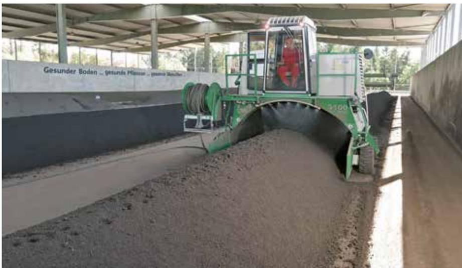
Die 80 Meter langen Mieten müssen regelmäßig mit dem „Gujer“ gewendet und befeuchtet werden.
