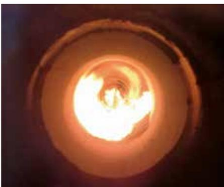
**Blick in das Innere des Drehrohr-ofens**
