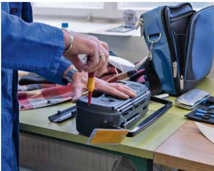
**Reiner Loch zerlegt ein Radio, bei dem der Lautstärkereger nicht mehr richtig funktioniert. In diesem Fall musste nur ein elektronisches Bauteil gereinigt werden, um die Funktion wiederherzustellen.**
