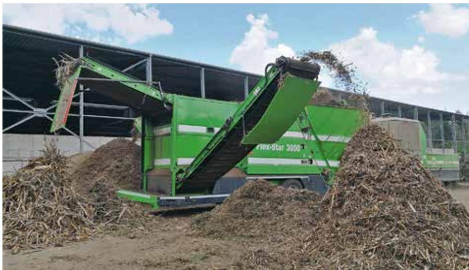
**Eine höchst effektive Maschinenkombination: Der Schredder und das nachgeschaltete Sternsieb verarbeiten bis zu 500 Tonnen Grüngut pro Tag.**
