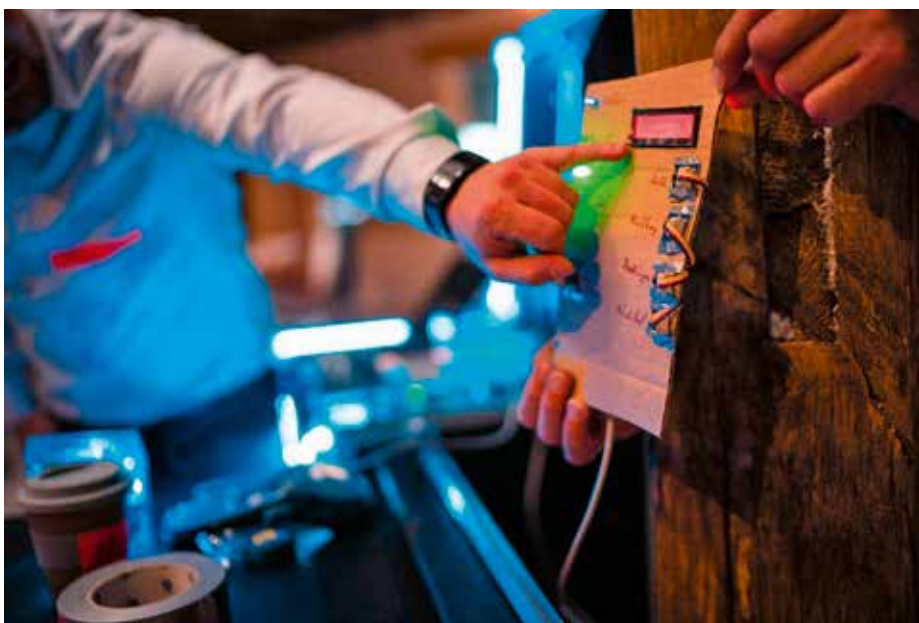
Abbildung 2: Prototyp Touch-Display Mitfahrbank auf Arduino-Mikrokontrollerbasis
