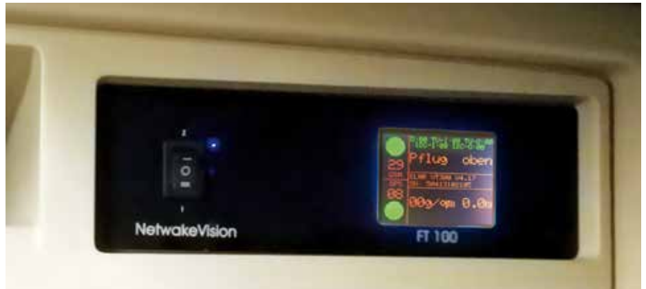
Technische Ausstattung im Winterdienstfahrzeug, FT100-eingebaut
